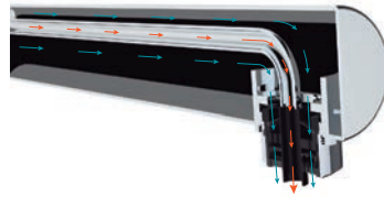
No existe comunicación entre el conducto de agua mezclada y el de agua tratada. It does not exist any contact between the mixed water channel and the treated one. Il n'y a aucun contact entre l'eau mitigée et l'eau purifiée
