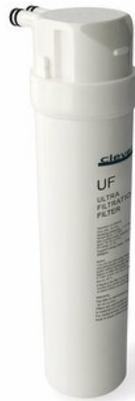
El cartucho **UF de ultrafiltración (0,02-0,1 µm)** es la última etapa del circuito de tratamiento del agua Pure. Se encarga de **filtrar bacterias y organismos restantes**. En el proceso de filtración, se filtraron partículas, sedimentos, óxidos y arena que arrastra el agua de red, se eliminaron olores y sabores, y se redujo el nivel de cloro, absorbiendo también las partículas más pequeñas. El tamaño de los cartuchos es muy compacto, 10", equivalente a 260-270mm.
