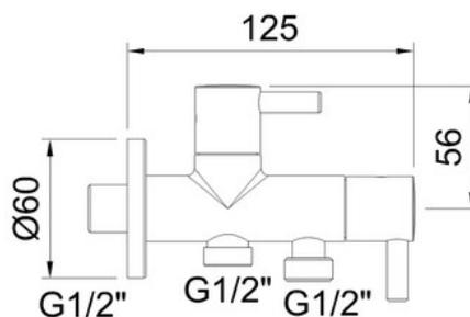
Válvula para ducha higiénica con salida cisterna. Ideal para los que desean eliminar el bidé y no quieren perder la funcionalidad, pudiendo así substituir la actual válvula de escuadra del llenado del WC, por este Shattaf con 2 monturas cerámicas que garantizan el uso frente al paso del tiempo. Se incluyen los accesorios de flexo, soporte a pared y ducha higiénica.
